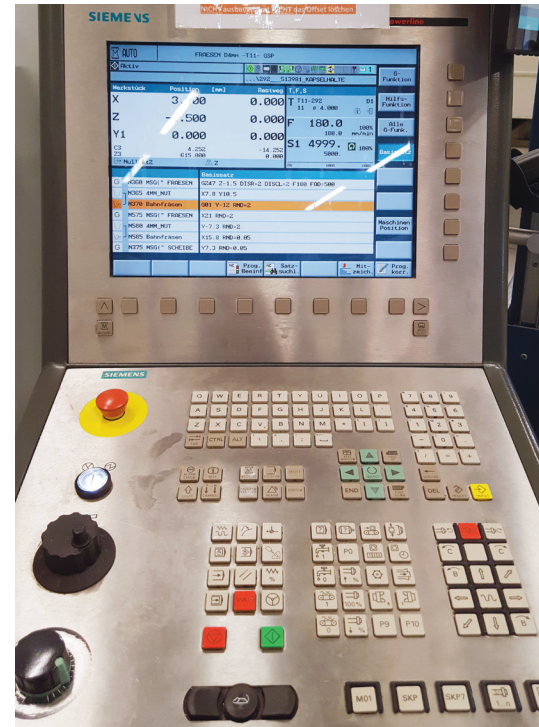
Aufgerüstet: alte Siemenssteuerung für die Nutzung maschineninterner Signale
